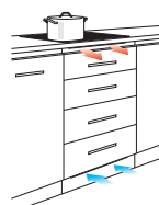
Ventilation recommandée ± 10 mm
