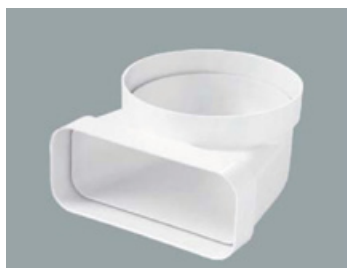
Coude vertical rond à rectangulaire Ø150. Courbe 220 x 90 mm
